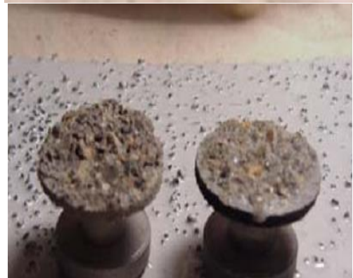
شکل ۵- آزمون بررسی چسبندگی پوشش پلی اوره به سطح
