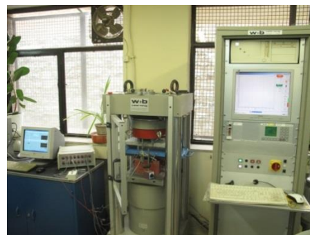
شکل ۲- مجموعه سیستم اعمال بار و ثبت خروجی‌ها قبل از آزمایش
