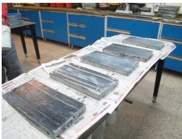
شکل ۱- نحوه چسباندن ورق CFRP به روش نصب تر
