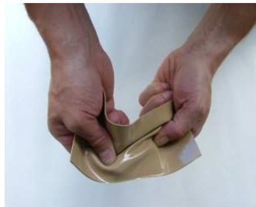
شکل ۳- نمایش انعطاف پذیری پوشش پلی اوره
