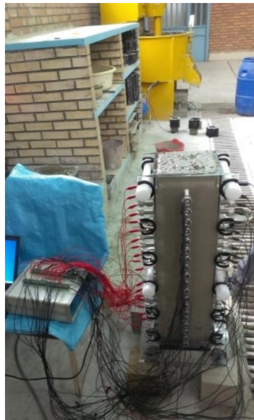
شکل ۴: نحوه انجام آزمایش مقاومت الکتریکی
