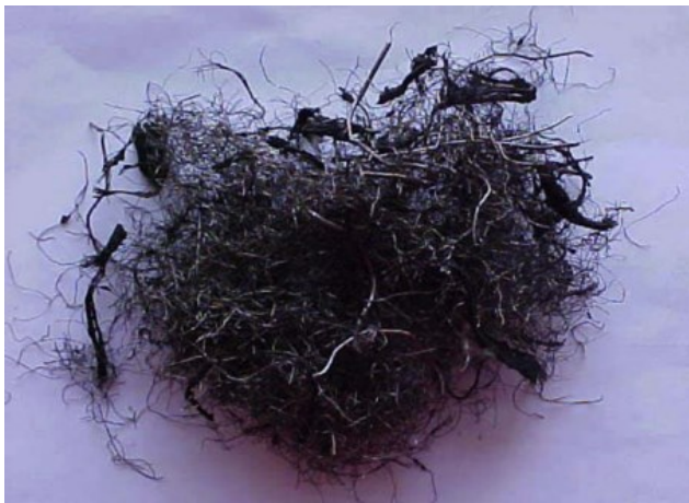
شکل ۲- الیاف فولادی به دست آمده از تایر فرسوده‌ی اتومبیل [۱۶]
