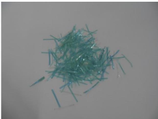
شکل ۳- الیاف رشته‌ای به دست آمده از بطری‌های PET [۲۲]
