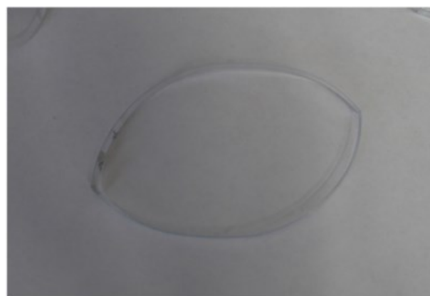
شکل ۴- الیاف حلقه‌ای به دست آمده از بطری‌های PET [۲۲]
