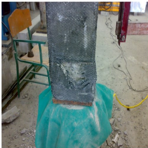
شکل (۱۰): پارگی FRP در نمونه آزمایشگاهی
