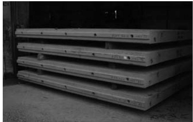
شکل ۷- نمونه ای از پنل‌های آماده انتقال به محل پروژه [۴]
