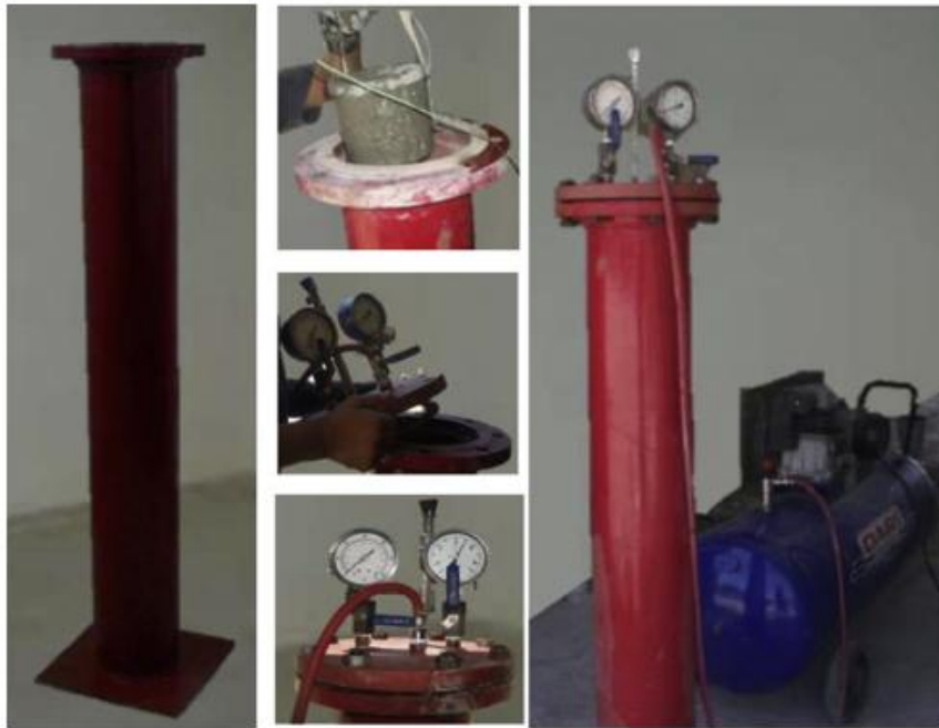
شکل ۶- آزمایش کاهش وزن در مخزن آب تحت فشار (کمی) [۶]
