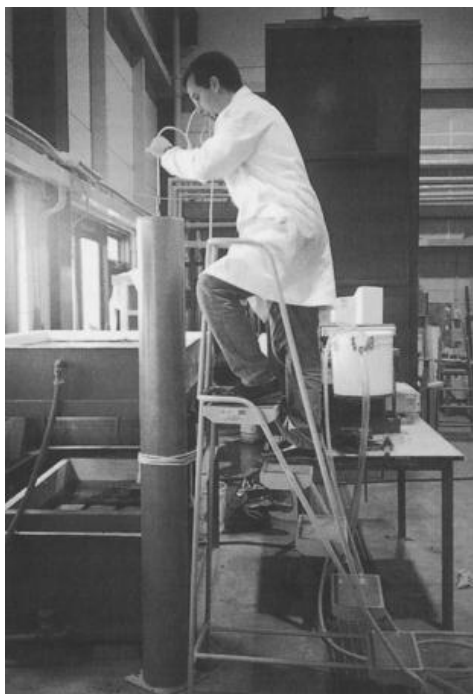
شکل ۳- آزمایش تعیین پایداری بتن تازه در برابر آب شستگی بتن CRD-C61 جهت بررسی کمی آب شستگی
