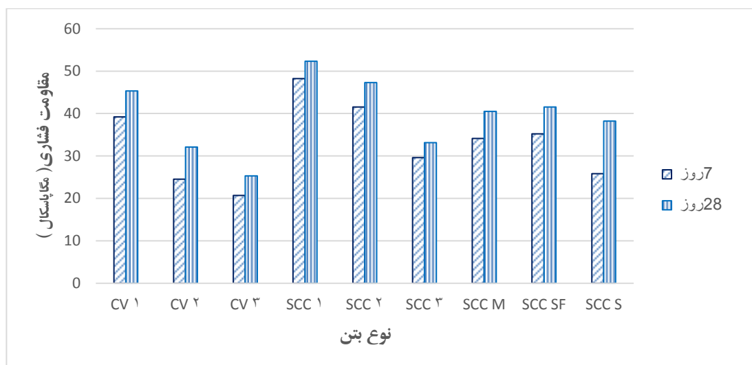
شکل ۳: مقاومت فشاری بتن ها، در سن ۷ و ۲۸ روزه
