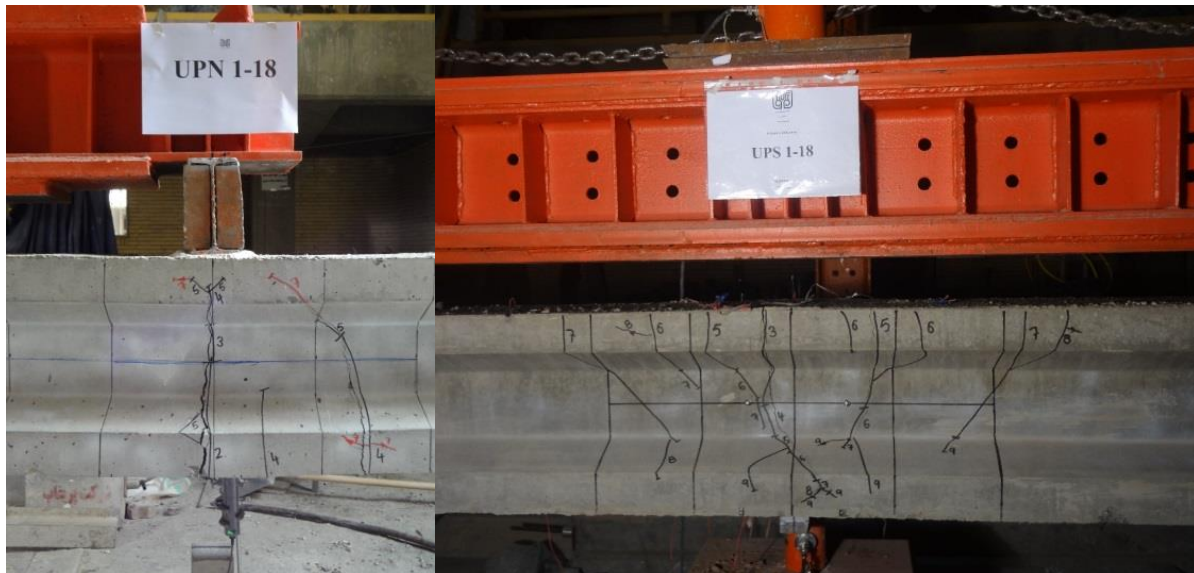
شکل (۷): آزمایش بارگذاری و تخریب تیرها
