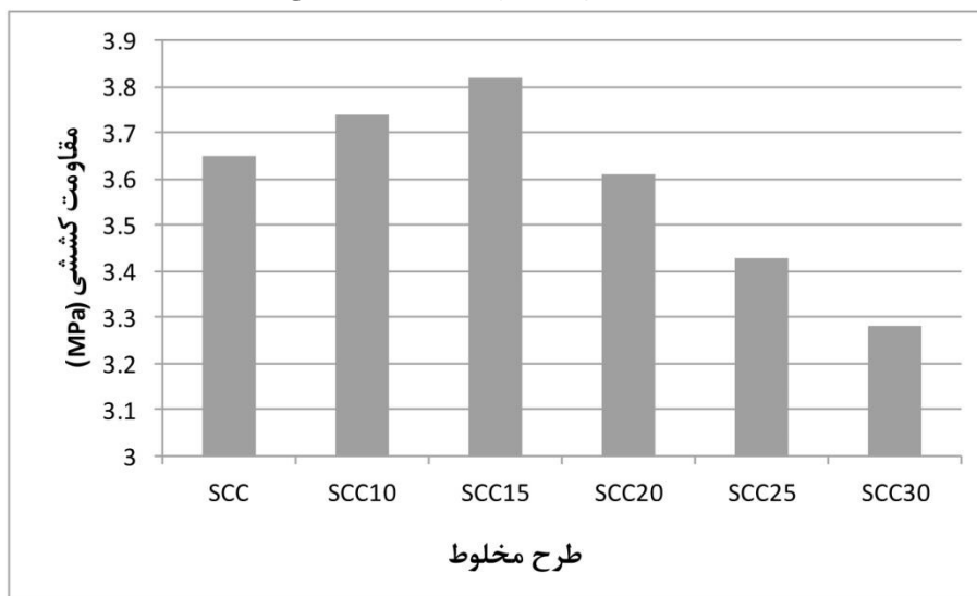
شکل (۸) نتایج آزمایش های مقاومت کششی
