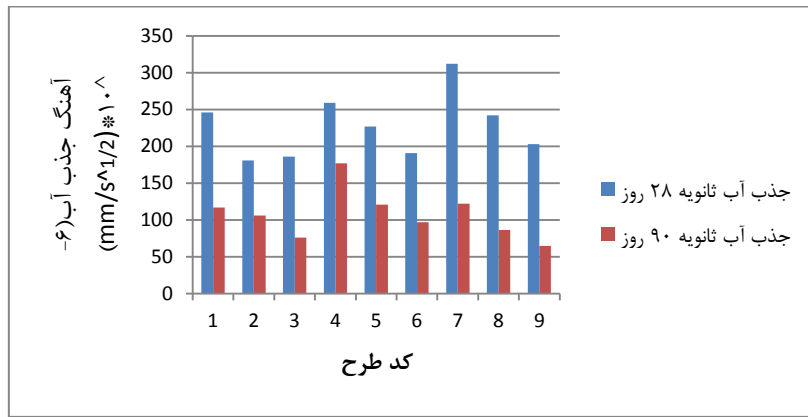
نمودار ۴- نتایج آزمایش آهنگ جذب آب ثانویه بتن در سن ۹۰ روز
