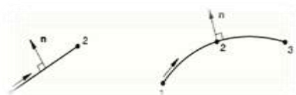
شکل ۵- تعریف بردار نرمال المان خربایی دو و سه گرہ ای [5]
