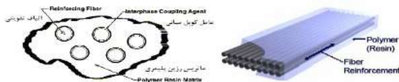
شکل ۱- اجزای تشکیل دهنده FRP [2]
