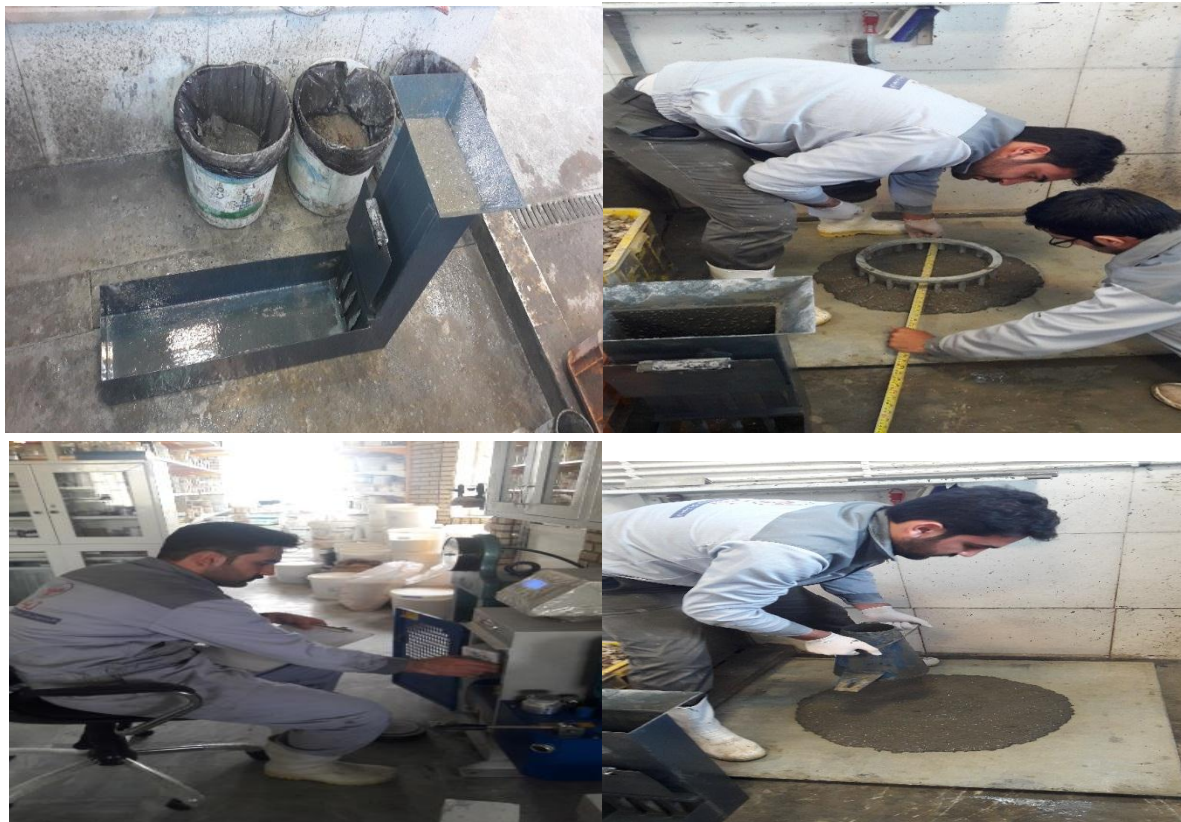
شکل ۴: عکس رئولوژی بتن خودتراکم، نمونه‌ها، شکستن نمونه‌ها
