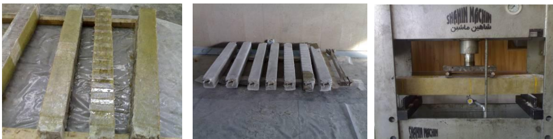
شکل ۳- نمونه‌های تقویت شده و نحوه‌ی بارگذاری آن‌ها
