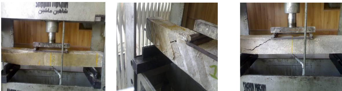
شکل ۵- شکست برشی در تیر BControl,2 و جدا شدن ورق تقویتی E-GFRP از سطح بتن
