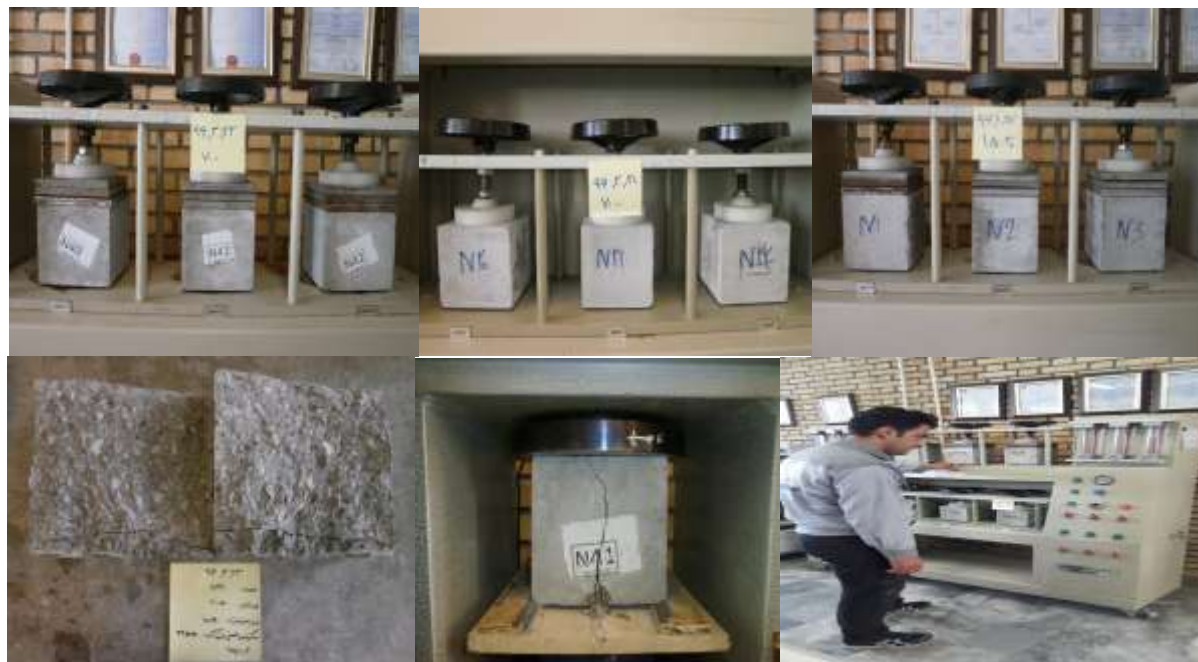
شکل ۶: آزمایش عمق نفوذ آب تحت فشار
