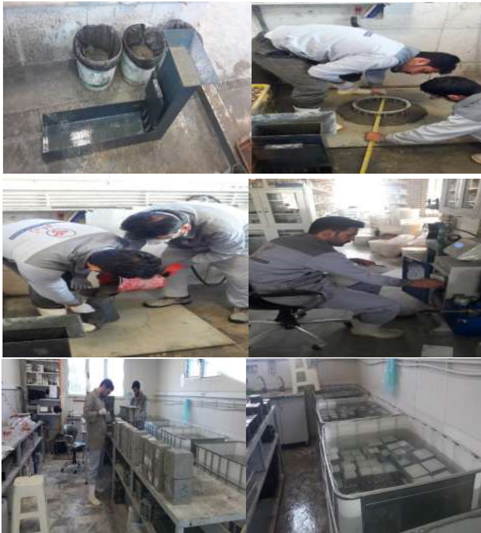
شکل ۵: عکس رئولوژی بتن خودتراکم، نمونه ها، شکستن نمونه‌ها
