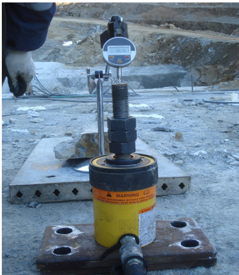
نمایی از آزمایش کشش انجام شده بر روی میلگرد آزمایشی
