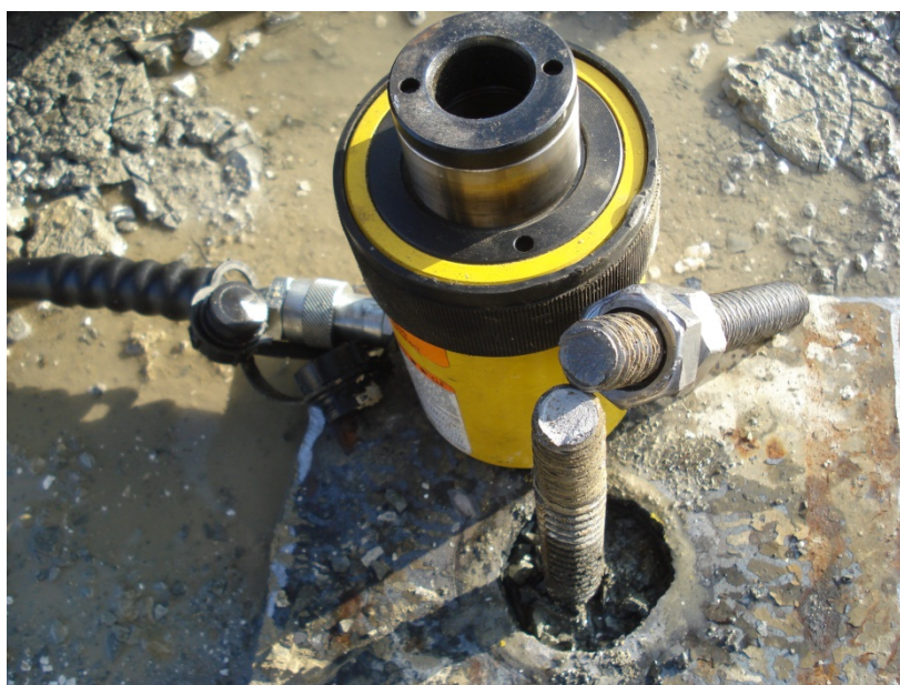
نمایی از میلگرد آزمایشی گسیخته شده تحت اثر کشش
