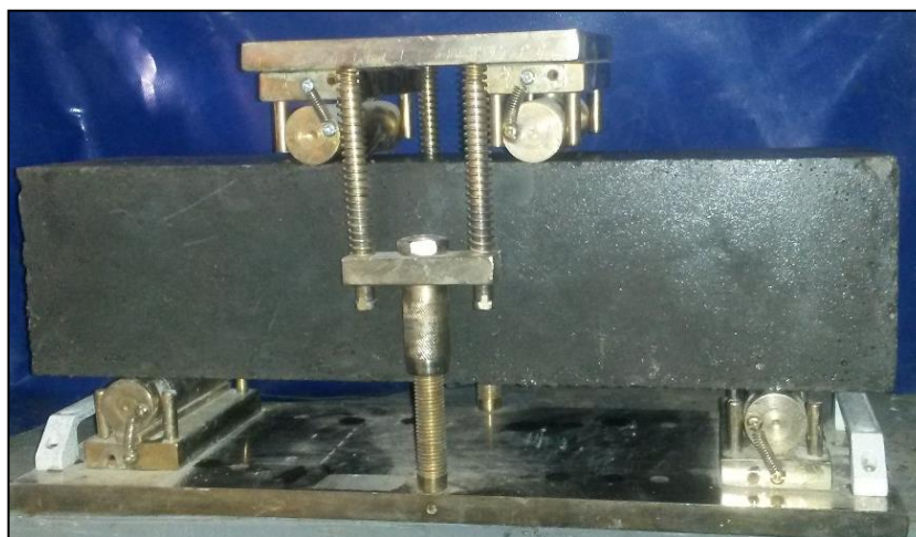
شکل ۵- محفظه آزمون مقاومت خمشی بتن (با استفاده از تیر ساده با بارگذاری در نقاط یک سوم)
