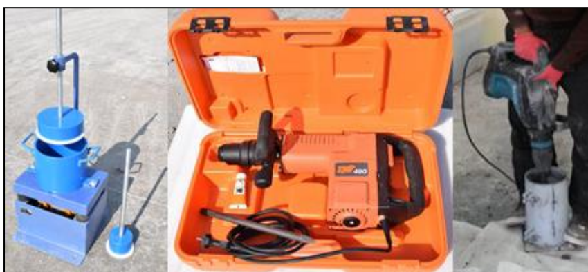
شکل ۳- دستگاه آزمون وی بی و چکش نمونه‌گیری استاندارد
