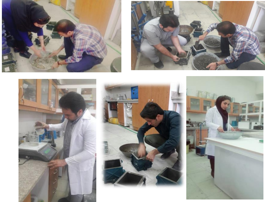
شکل ۱. مراحل تهیه بتن، قالب ریزی در آزمایشگاه تخصصی بتن
