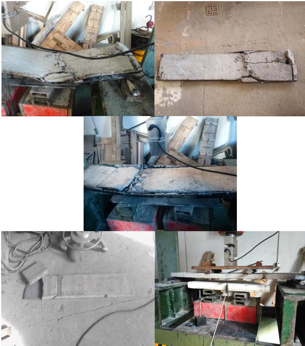
شکل ۱- شکست دال های بتنی در آزمایش خمش
