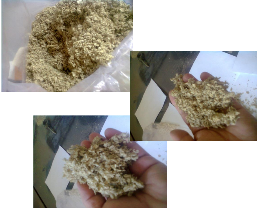
۲- دفیبر کردن با سیستم پنوماتیکی باعث جدا شدن کامل الیاف از هم می شود
