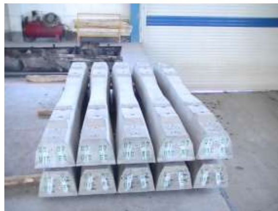
شکل ۵. تراورس بتنی پیش‌تنیده B70.
