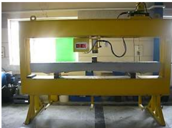
شکل ۶. سیستم جک آزمایش سه نقطه‌ای خمشی.
