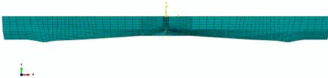
شکل ۱. مدل سه بعدی تراورس بتنی پیش تنیده B70
