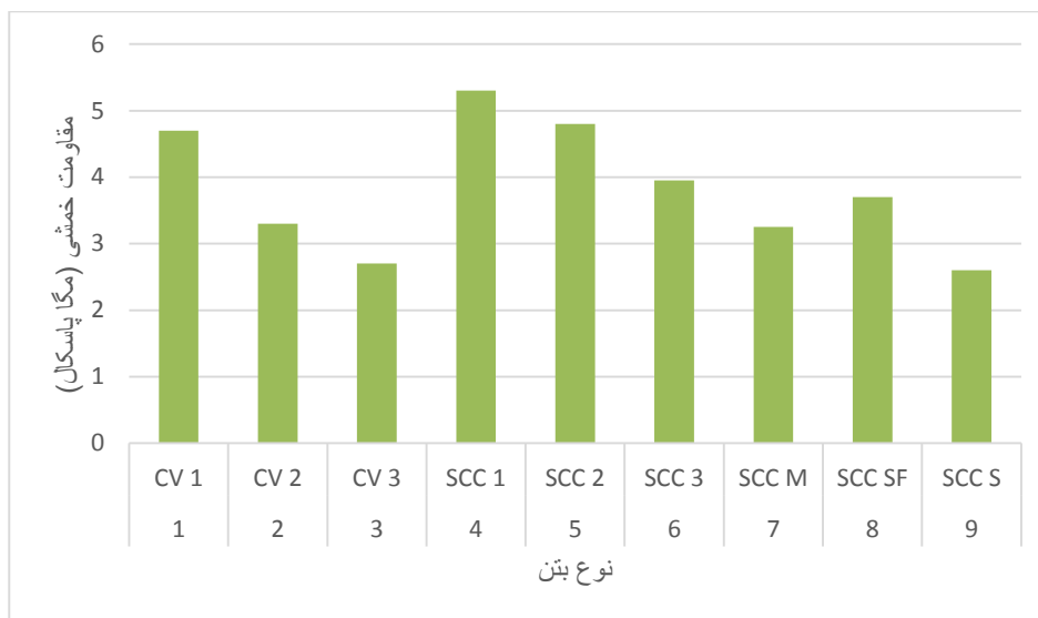
شکل ۴: مقاومت خمشی مخلوط های بتن ساخته شده در تحقیق
