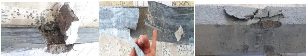
ب) تیرهای بتن سبک (به ترتیب از راست): LWCB.GM - LWCB.EBR - LWCB
