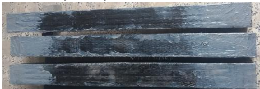
ب) تقویت ناحیه کششی تیرهای بتن مسلح سبک و نرمال با ورق CFRP شکل ۲-۲: تقویت تیرهای بتن مسلح سبک و نرمال با ورق CFRP
