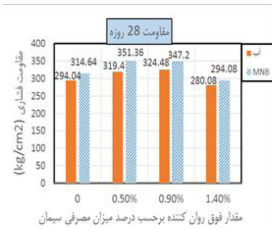
شکل ۸- مقاومت فشاری ملات سیمان با آب و میناب در حضور درصد های مختلف فوق روان کننده در سنین ۷ و ۲۸ روزه
