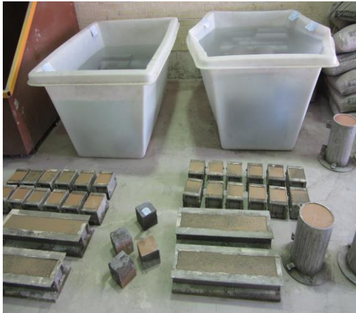
شکل ۶- نمونه‌های بتن خودتراکم در آزمایشگاه
