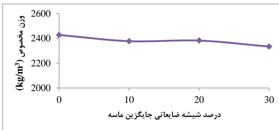
شکل ۹- میانگین وزن مخصوص نمونه‌های تیر خمشی (۱۰×۱۰×۵۰) سانتی‌متر برای سن ۲۸ روزه و درصدهای مختلف شیشه ضایعاتی
