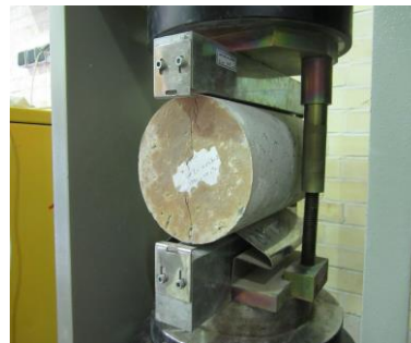
شکل ۷- نحوه انجام آزمایش‌های، الف: کششی، ب: خمشی
