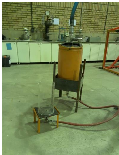
شکل ۴- سمت چپ: ابعاد سیستم نمونه گیری، سمت راست: سیستم های تحت فشار و نمونه گیری ساخته شده
