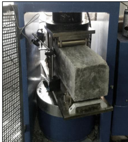
شکل ۶. آزمایش شکست تیر خمشی
