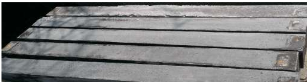
شکل ۱-۲: تیرهای بتن آرمه ساخته شده
