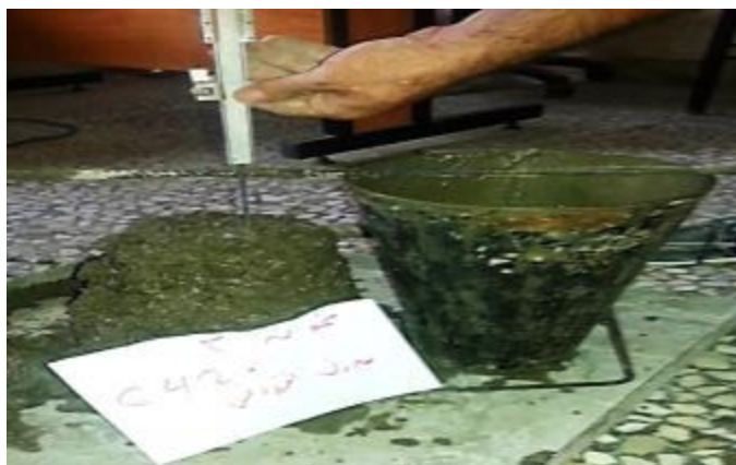
شکل ۹ آزمایش اسلامپ طرح اختلاط بتن روسازی با استفاده از فوق روان کننده (بالا) و بدون استفاده از آن (پایین)
