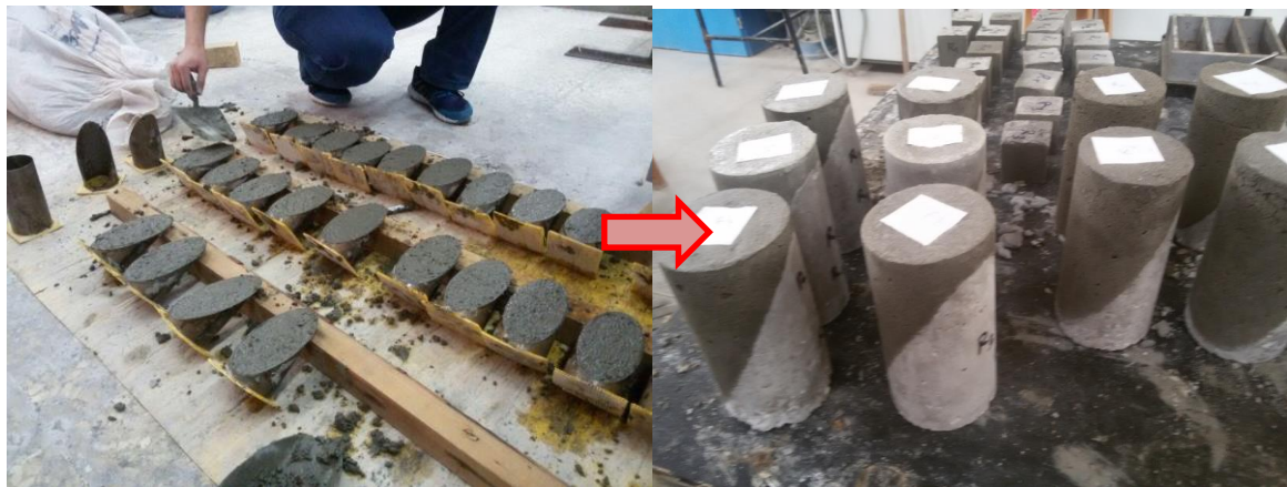
شکل ۱ مراحل ساخت نمونه‌ها برای آزمایش مقاومت پیوستگی
