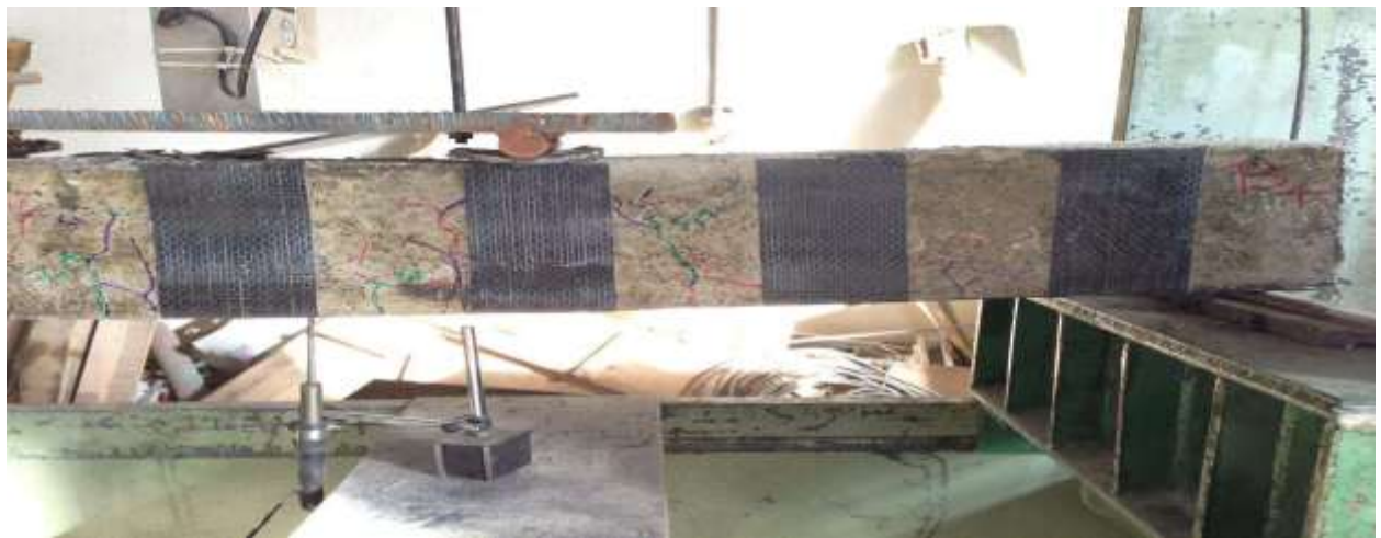
شکل شماره ۷ - تیر B4 پس از بارگذاری
