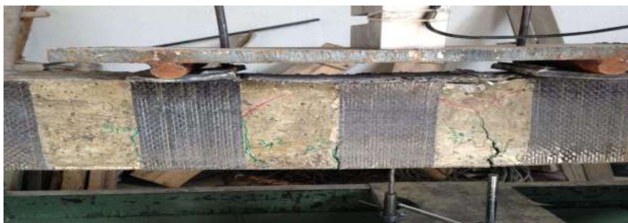
شکل شماره ۴ - تیر B1 پس از بارگذاری
