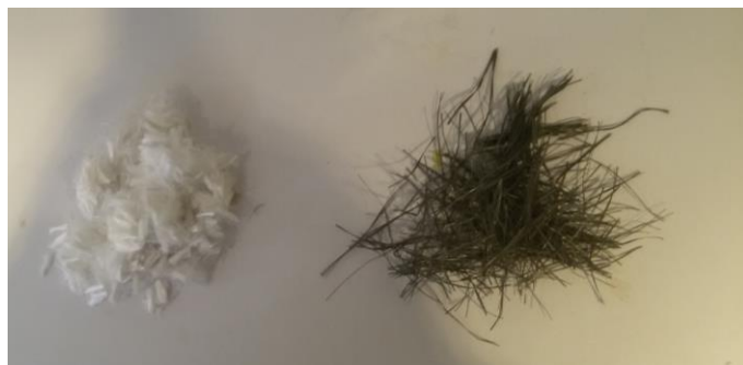
شکل (۴) - نمونه ای از الیاف های بکار برده شده (pp and forta)
