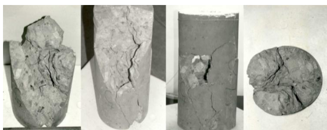
شکل ۴- قلوه‌کن‌شدن؛ آزمون‌های حرارت دیده تا دمای 300^{\circ}\text{C} [۱۹]
