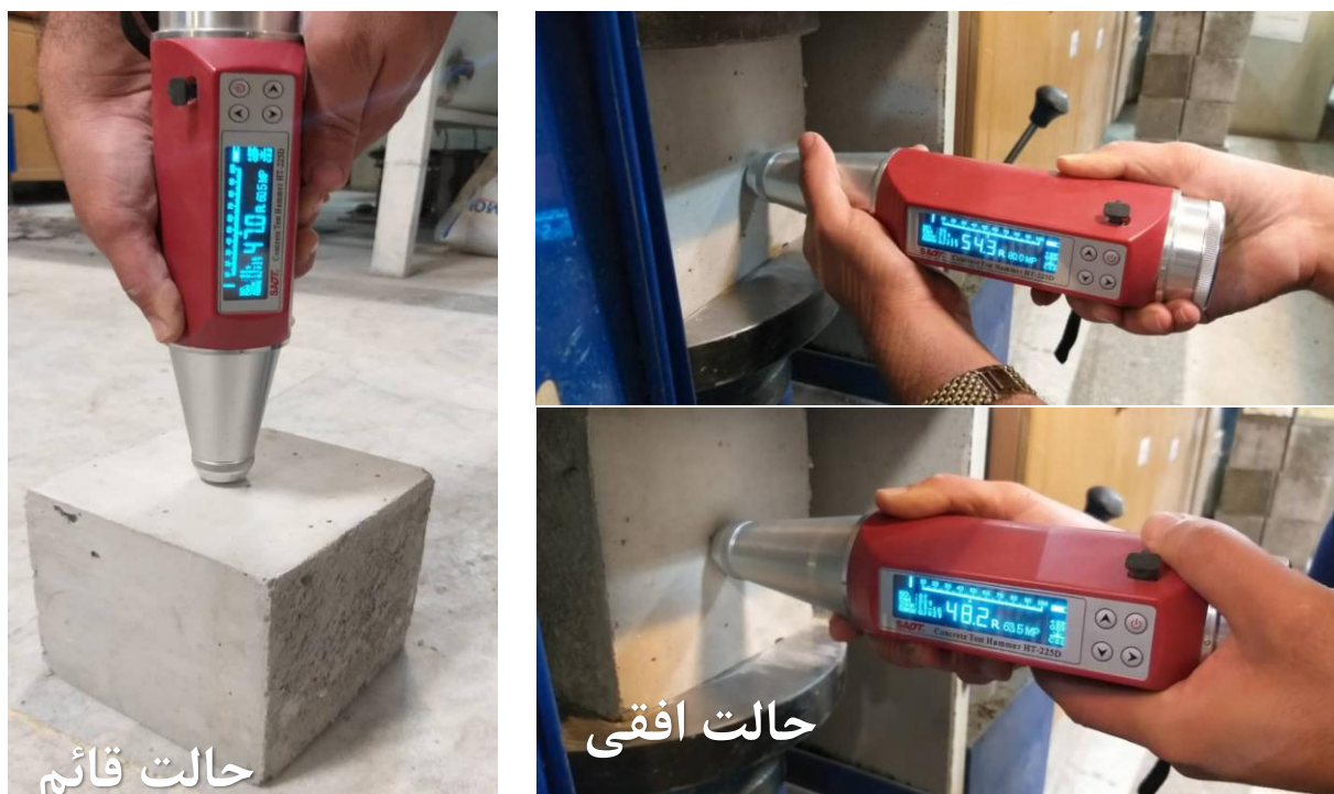
شکل ۱- حالت افقی و قائم اندازه‌گیری اعداد برجهندگی با استفاده از چکش اشمیت
