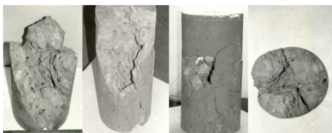
شکل ۴- قلوه‌کن‌شدن؛ آزمون‌های حرارت دیده تا دمای 300^{\circ}\text{C} [۱۹]
