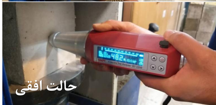
شکل ۱- حالت افقی و قائم اندازه‌گیری اعداد برجهندگی با استفاده از چکش اشمیت
