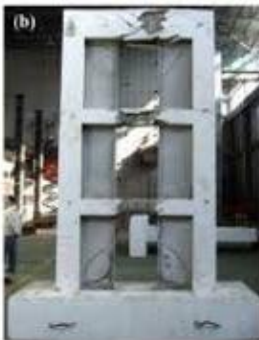
شکل ۳- شکل هندسی نمونه صحت سنجی شده دیوار برشی بتنی مطالعات آزمایشگاهی Wang و همکاران
