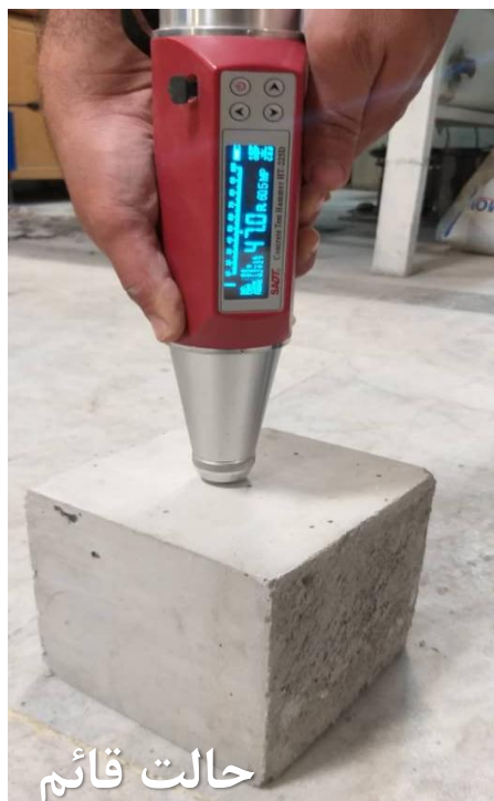
شکل ۱- حالت افقی و قائم اندازه‌گیری اعداد برجهندگی با استفاده از چکش اشمیت
