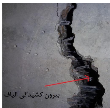
شکل ۴- تصویری از یک نمونه در حال آزمایش (سمت چپ) و سطح شکست بتن پس از آزمایش (سمت راست).
