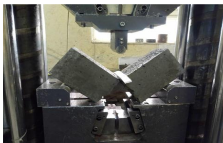
شکل ۱۲- نحوه گسیختگی آنی نمونه فاقد الیاف (PC)
