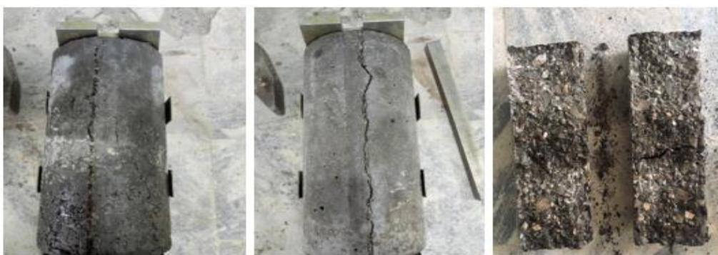
نمونه با الیاف ۱۲ میلی متر نمونه بدون الیاف نمونه با الیاف ۲۴ میلی متر
