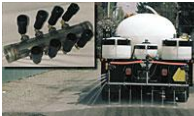
شکل ۱ روش مکانیزه پخش مواد ضد یخ در سطح روسازی [۳].
