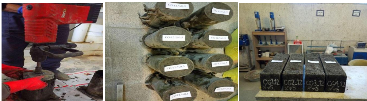
شکل ۱- متراکم سازی نمونه با استفاده از چکش ارتعاشی رونیکس
