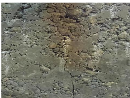
شکل ۱۶- نحوه ترک خوردگی نمونه حاوی الیاف ۲۴ میلی متر
