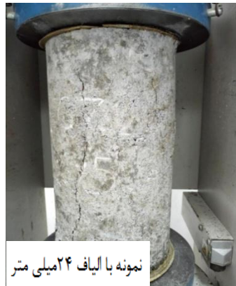
شکل ۶- نحوه گسیختگی نمونه‌ها تحت فشار
