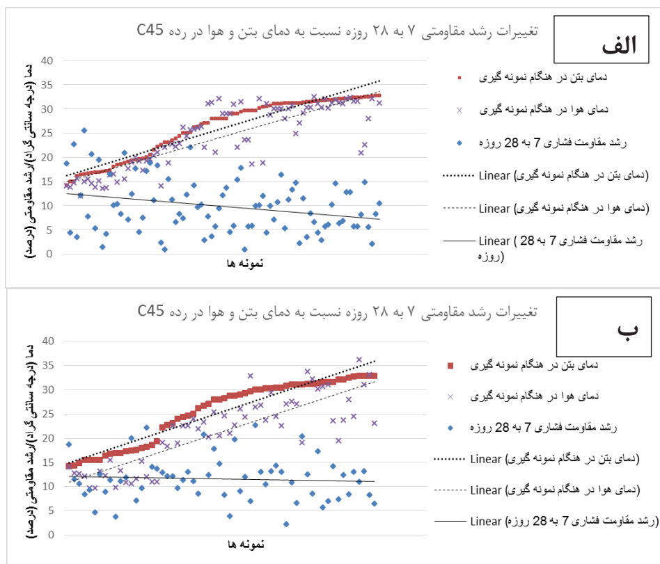
شکل ۱۱- نحوه تغییر درصد رشد مقاومتی بتن از ۷ به ۲۸ روز با تغییرات دمایی برای رده C45 (الف- با استفاده از روان کننده L و ب- با استفاده از روان کننده C)
