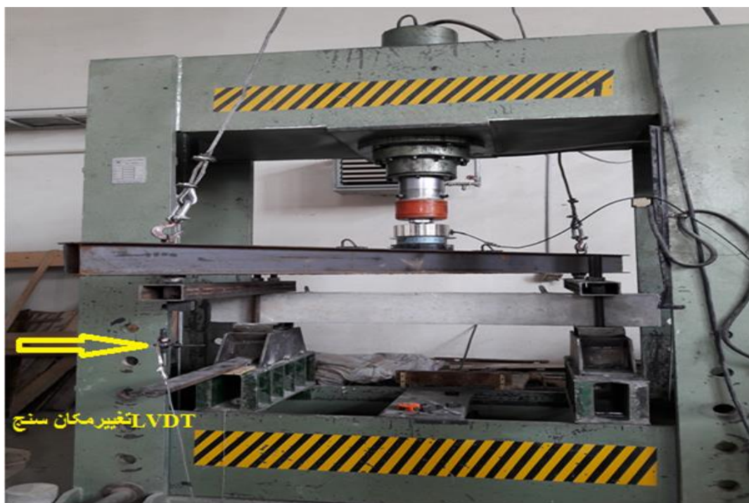
شکل ۴-۲ نمای از دستگاه بارگذاری
