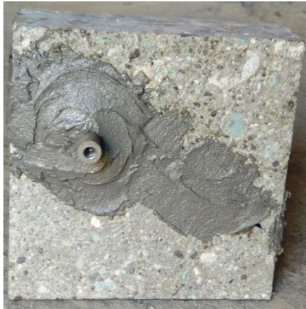
شکل ۲: آماده‌سازی نمونه‌های شکسته شده برای تزریق
