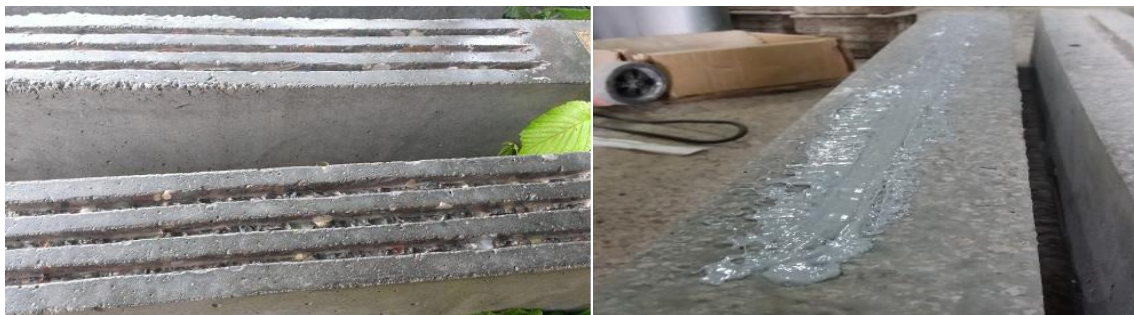
الف) به ترتیب از راست: تقویت ناحیه فشاری با رزین، شیارزنی ناحیه کششی تیرهای بتن سبک و نرمال
